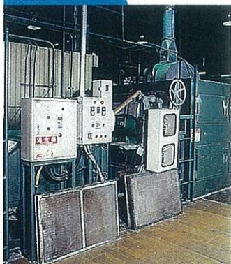
●真空包装前に事前処理する事により製品内部の温度・湿度を一定に制御します。
